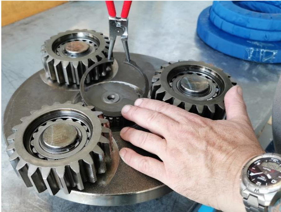
Montage der geprüften und gereinigten Komponenten
