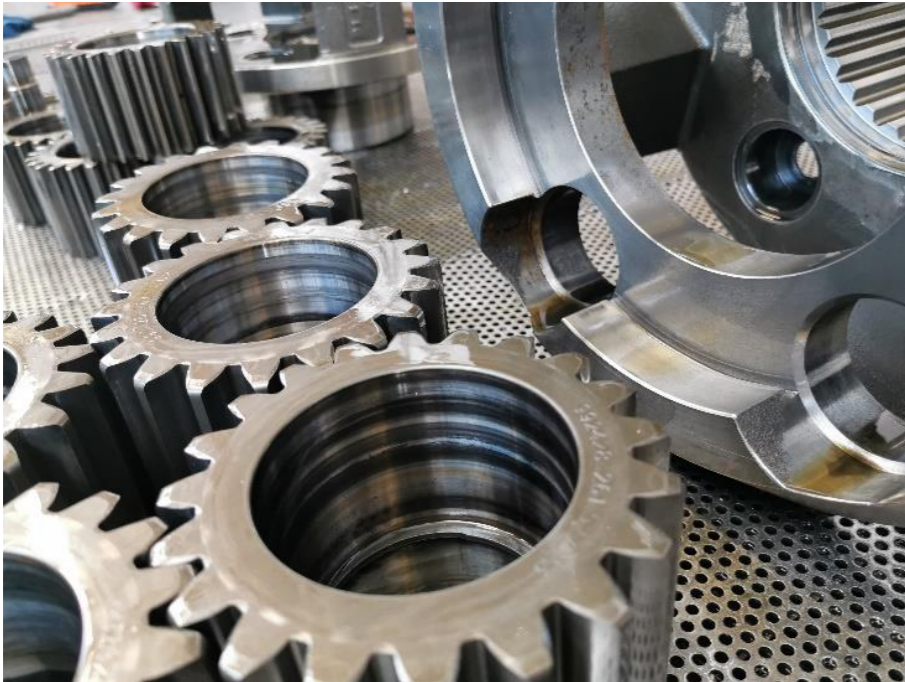
Komplette Demontage des Aggregats
