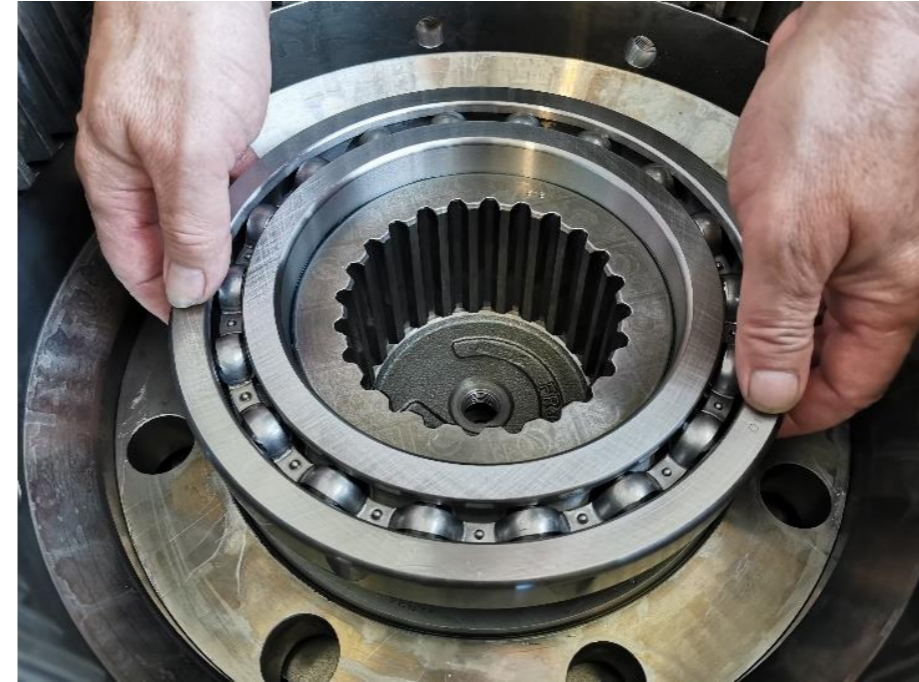
Montage neuer Wälzlager und Dichtungen
